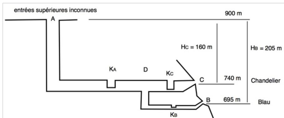
Fig. 5 : Le réseau est schématisé par deux conduits et trois rétrécissements (ces derniers causant toutes les pertes de charges)
