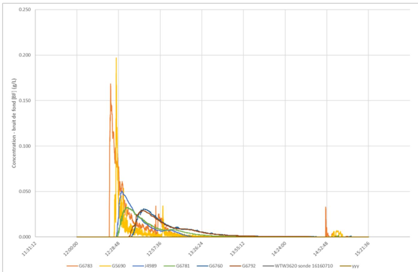
**Figure 2 : Chroniques de conductivité lors du jaugeage de la rivière de la Combe aux Prêtres, doublets 1, 2 et 3**
