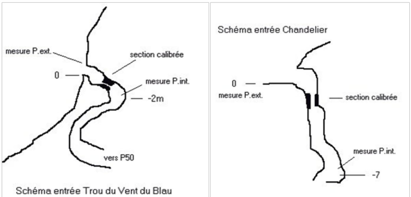
**Fig. 9 et 10 : positions respectives des sections de calibration et mesures au Trou du Vent et au Chandelier**
