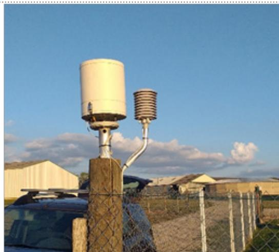
*Pluviomètre et station de température*
