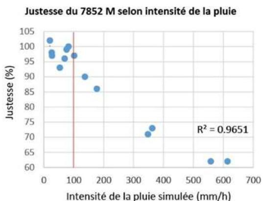
Sensibilité du pluviomètre à l'intensité des pluies réelles ou simulées
