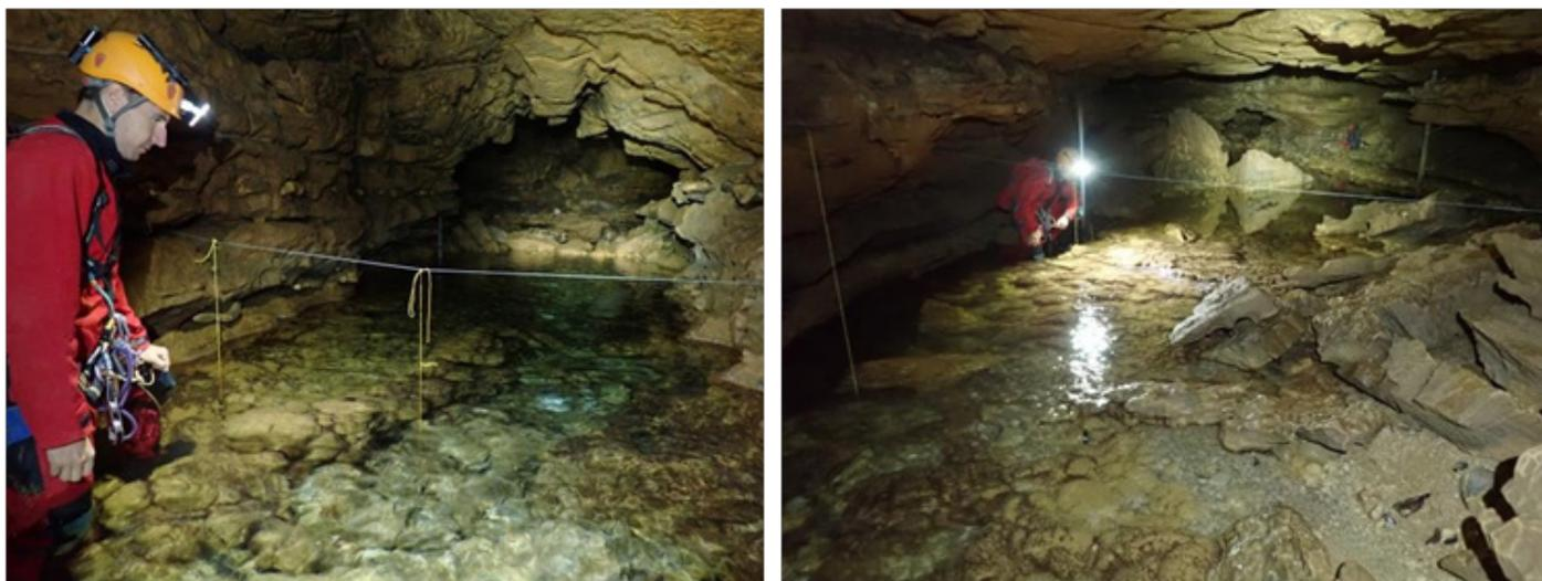
Figure 1 : Positionnement des sondes de conductivité (photographie Vincent Schneider, sujet Thomas Gaslonde)
