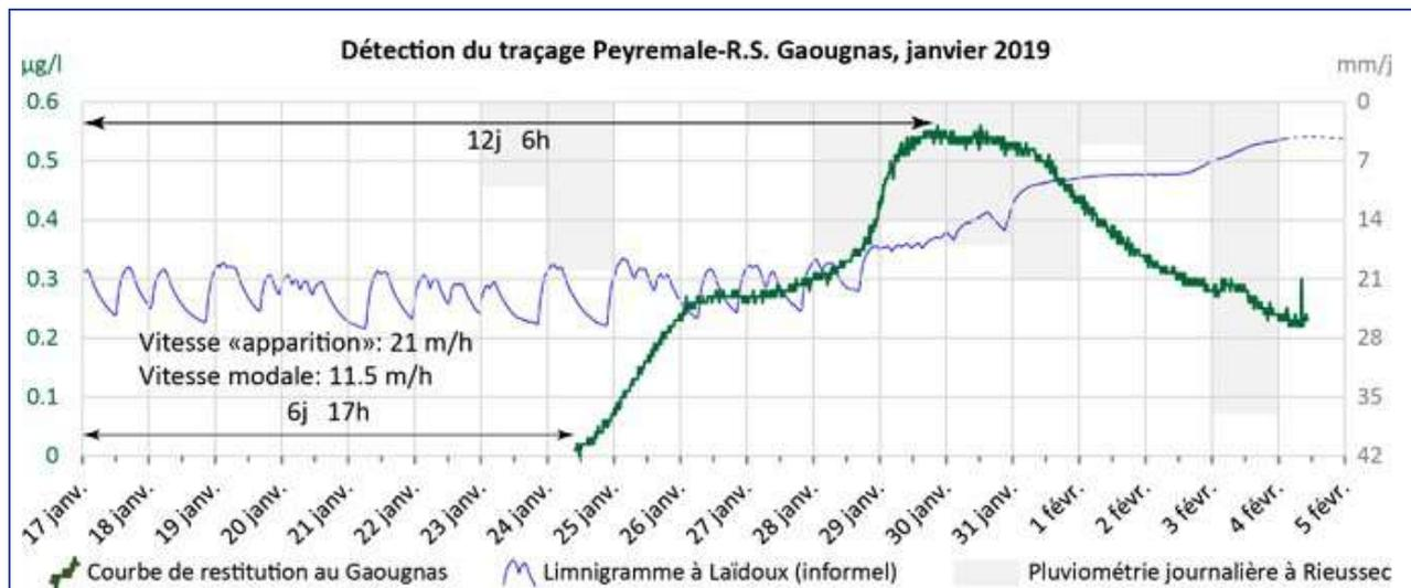
Figure 27 : Détection du passage de la fluorescéine dans la rivière souterraine du Gaougnas, et pluviométrie locale synchronisée (L. Fabre, Rieussec). En arrière-plan le limnigramme des intermittences à Laidoux, sans échelle (P. Hannover) (©SCM 2019).
