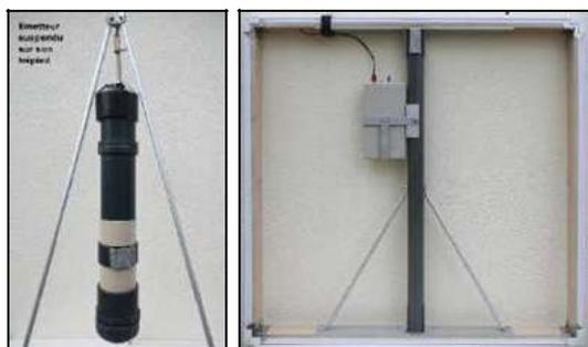
L'antenne est constituée d'un solénoïde dont le noyau est formé par 8 ferrites de 20 mm d'épaisseur et de 50 mm de diamètre formant un noyau de 156 mm de long.
