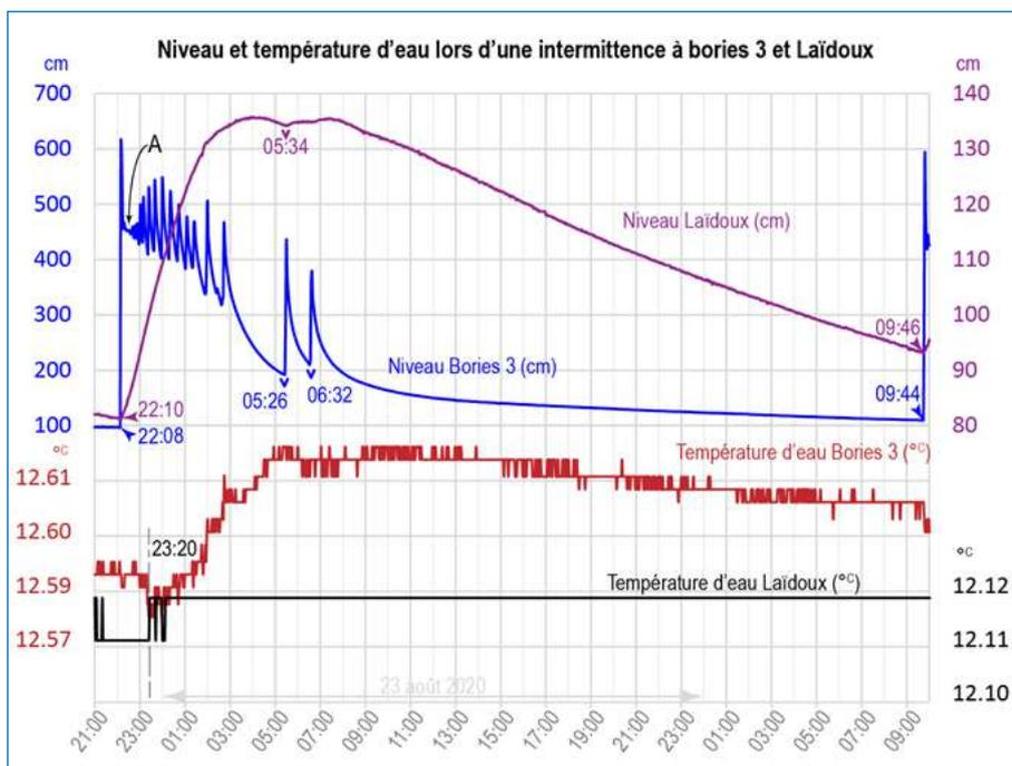
Figure 9 : L'intermittence du 23 août 2020, enregistrée à un pas d'enregistrement de deux minutes, à la source de Laïdoux et dans le siphon de l'aven de Borie 3. A noter que les échelles de niveau sont disproportionnées.
