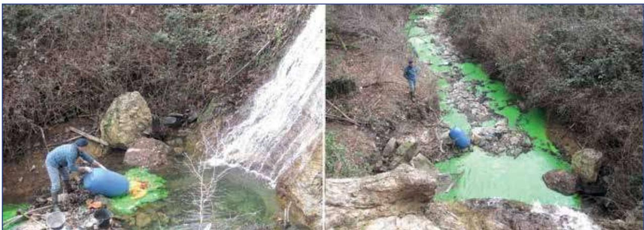
Figure 28: Injection de la fluorescéine sous la cascade de Peyremale (Ch. Bès).
