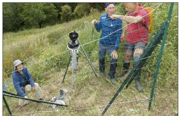
Figure 14 : à 473 m d'altitude, le pluviomètre automatique d'Argentières est représentatif de la moyenne des pluies collectées par le bassin d'alimentation (cliché Ch. Bès).
