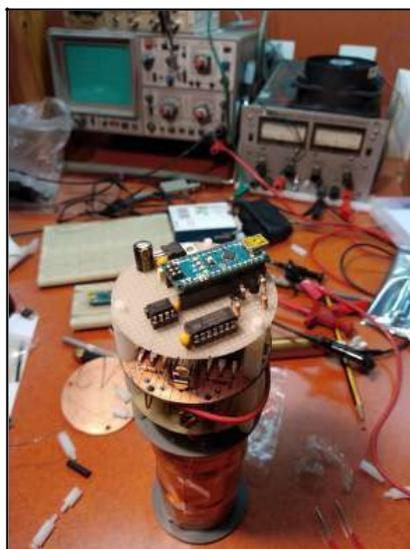
De développement en développement, il a finalement adopté une fréquence de 8,275 kHz qui se situe dans la gamme VLF, en-dessous des 8,3 kHz qui ne nécessite pas d'autorisation de fréquence. La fréquence est suffisamment basse pour une bonne précision et rester dans la légalité et suffisamment haute pour une bonne portée et loin des fréquences perturbatrices.
