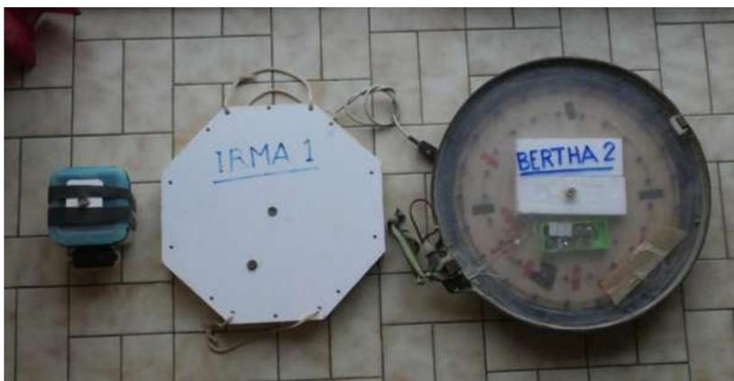
L'émetteur génère une fréquence peu adaptée et non réglementaire (1 MHz) émise à l'origine à travers une boucle unique de 1 mètre de diamètre montée sur une armature démontable et facile à transporter en siphon. L'intérêt du choix de cette fréquence est qu'elle nous a permis de ne pas avoir à construire de récepteur.
