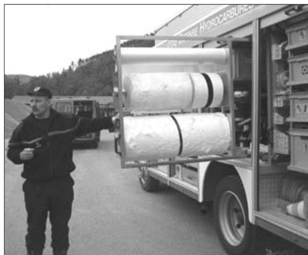
véhicule spécialisé pour les interventions en tunnel lors des sinistres liés aux hydrocarbures
