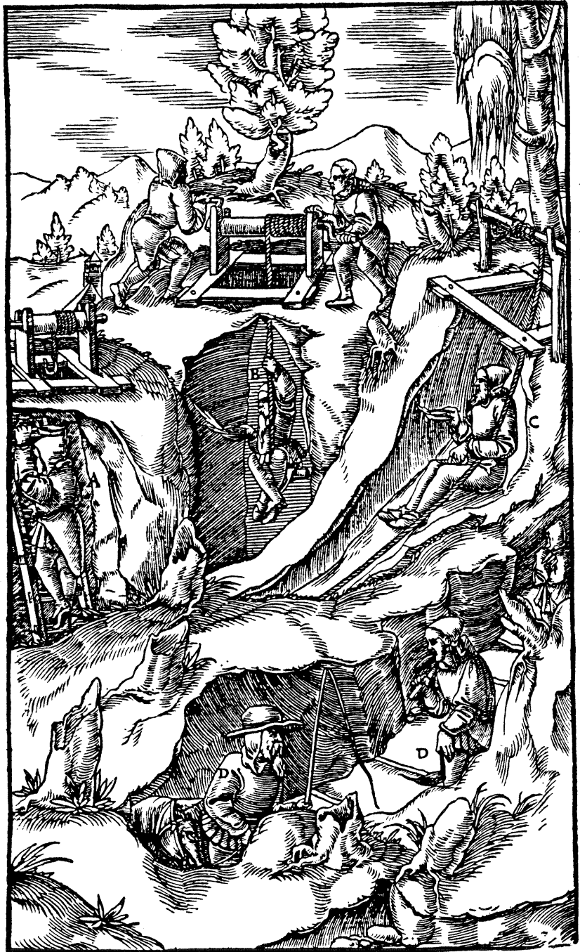
A : Descente dans le puits par des échelles B : Descente sur un siège C : Descente, assis sur du cuir D : Descente par des escaliers
