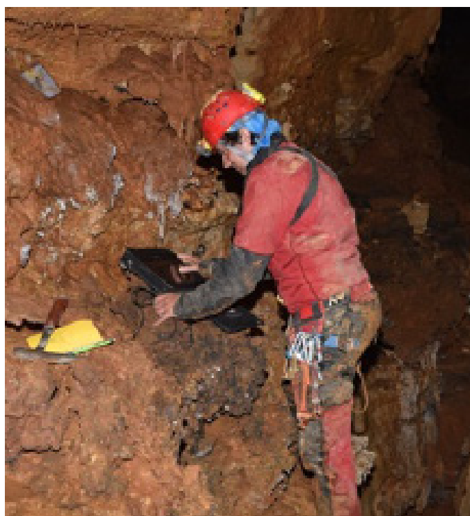
Paramétrage d'une sonde d'enregistrement de température (photo : D. Lamotte)
