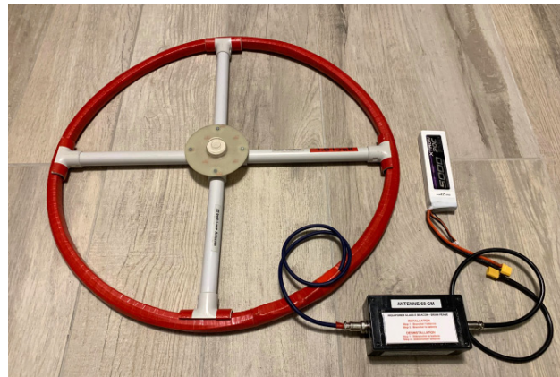
Fig. 15 – L'antenne d'émission de 60 cm de diamètre, son émetteur et la batterie LiPo d'alimentation
