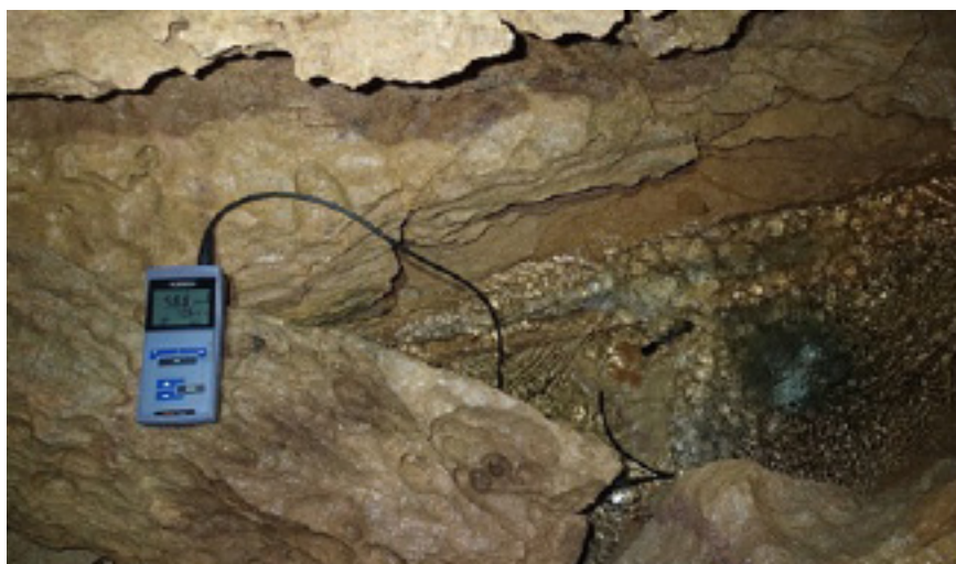
Sonde conductimétrique à l'amont de la Cascade (photo : J-F. Balacey)
