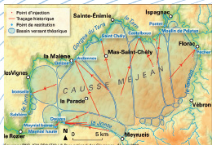
Figure 1 : résultats de la pré-étude hydrogéologique de 2013. Ils ont permis de proposer une première représentation des contours des bassins d'alimentation des principales sources.
