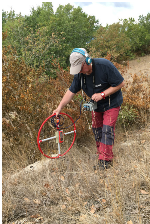
Radiolocalisation au-dessus du réseau Shadoks – Rainette – Grospierrres - Chandolas – Ardèche Photo : Jean-Louis Galéra
