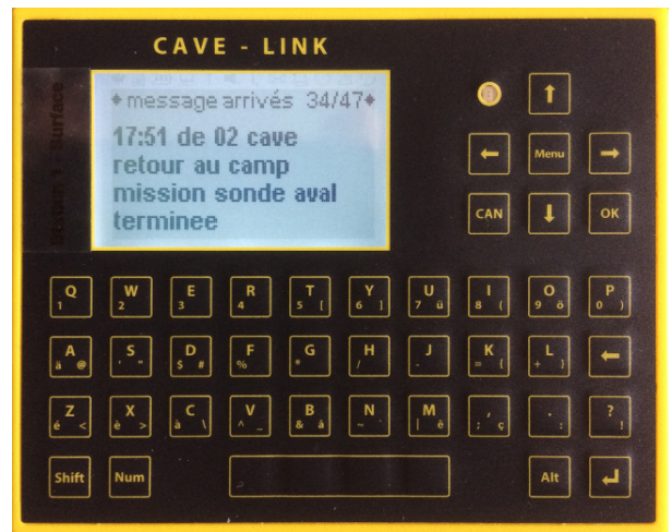
Fig. 21 – Le Cave-Link est un boîtier compact de 650 grammes mesurant L 120 mm x l 95 mm, H 55 mm
