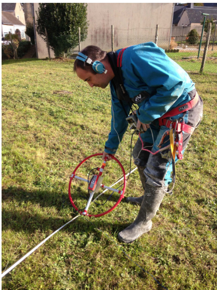
Fig. 10 – Mesure de l'angle de champ pour le calcul de la profondeur
