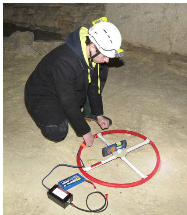
Fig. 16 – L'antenne d'émission de 60 cm de diamètre, en situation dans une carrière souterraine
